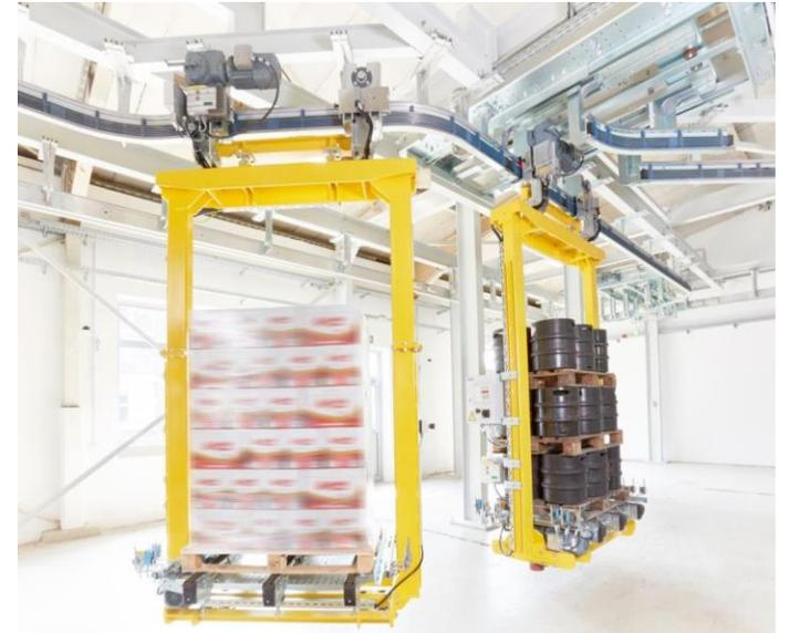
El conveyor se adapta a cada trazado. Este sistema puede igualmente **combinarse con otros sistemas de conveyor**. Velocidad de marcha 120m/minuto hasta 250 m/min. Inflexión 90°.
